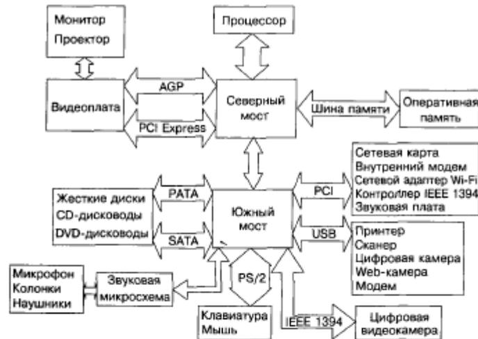
Рис. 1.3. Логическая схема системной платы
